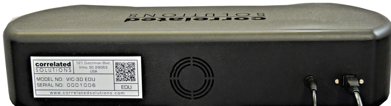
图3:VIC-EDU测量头后面板照片。矩形USB线用于摄像头。圆形电缆为电源连接
